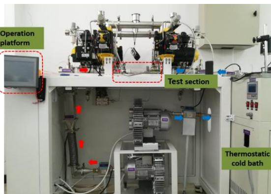
多孔介质内部流动换热实验平台
